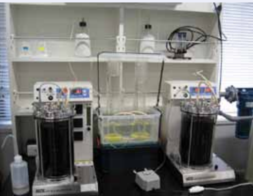
Лабораторное оборудование по производству биогаза путем анаэробного разложения галофитных растений (Фото Натальи Акиньиной)
